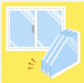
2枚以上のガラスの間に乾燥空気やアルゴンガスなどを封入した複層ガラス。ペアガラス（2層）は従来の単板ガラスと比較して断熱性能が大幅に向上。トリプルガラス（3層）はさらに高い断熱効果を発揮し、寒冷地で特に
